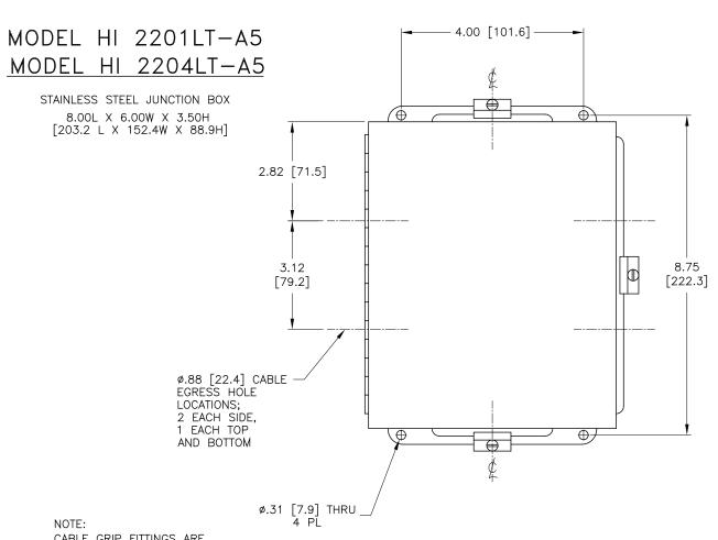
CABLE GRIP FITTINGS ARE CORROSION RESISTANT NYLON 1/2" NPT.
