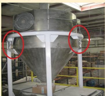
在某个有机谷物的生产工厂里，客户需要安装一个连续配料系统，要求所有批次的配方和命令都可以存储在PLC里面。为了节省成本，客户希望在这个配料系统里只配备一个称重料斗。四种物料通过气动输送系统按配方依次送入计量斗。当所有的配料都被送入后，底部的滑门被打开。使用一个气动锤清除物料，并在搅拌器里进行混合。然后混合料被送到临时料斗，按照正确的总量打包。
