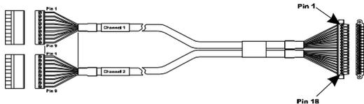
**FIG. 3-12 RTA CABLE ASSEMBLY - HI 17562WS DUAL CHANNEL**
