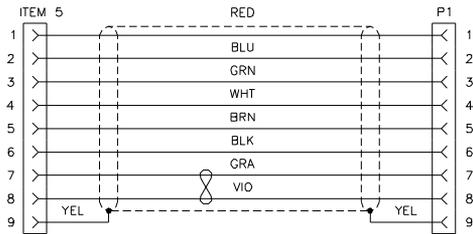
**FIG. 3-11 RTA CABLE SCHEMATIC - HI 1756WS SINGLE CHANNEL**
