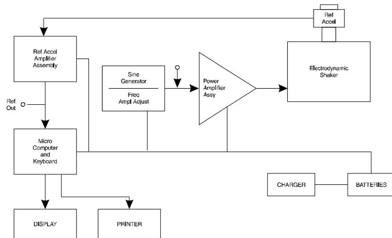
**FIG. 1-1 BLOCK DIAGRAM HI-813**
