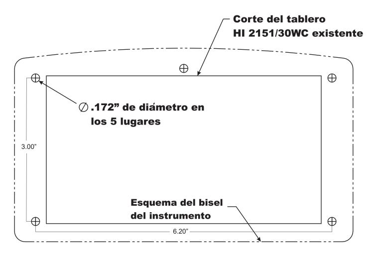
Plantilla de modificación para series HI 4000. Verifique las dimensiones del papel antes de utilizar este patrón. Para imprimir este patrón ajuste el "Page Scaling" a "none."
