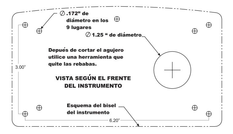
Plantilla de recorte para el tablero de montaje serie HI 4000. Verifique las dimensiones del papel antes de utilizar este patrón. Para imprimir este patrón ajuste el "Page Scaling" a "none."
